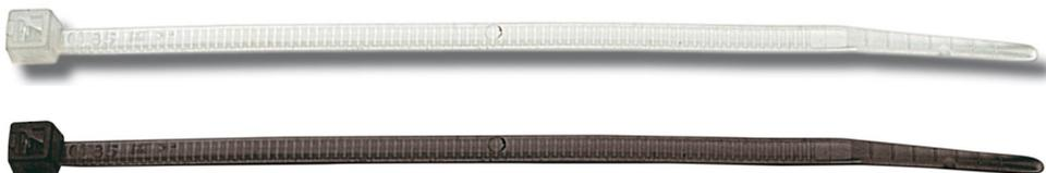
Standardowe opaski kablowe są produkowane wyłącznie z poliamidu 6.6, aby uniknąć problemów z segregowaniem materiałów (na przykład podczas recyklingu) lub interferencji w urządzeniach elektronicznych. Do czarnych opasek dodawana jest sadza, która poprawia odporność na promieniowanie UV w przypadku zastosowań zewnętrznych.
